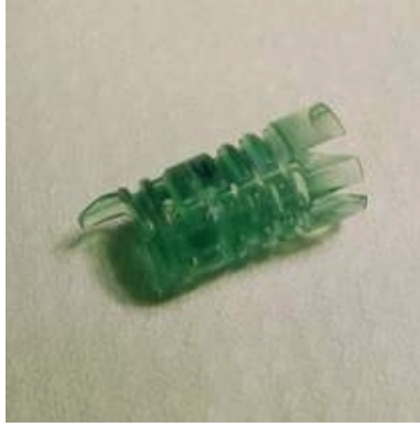
Abbildung 23: Abgebrochene Zapfen an der Stopperspitze
