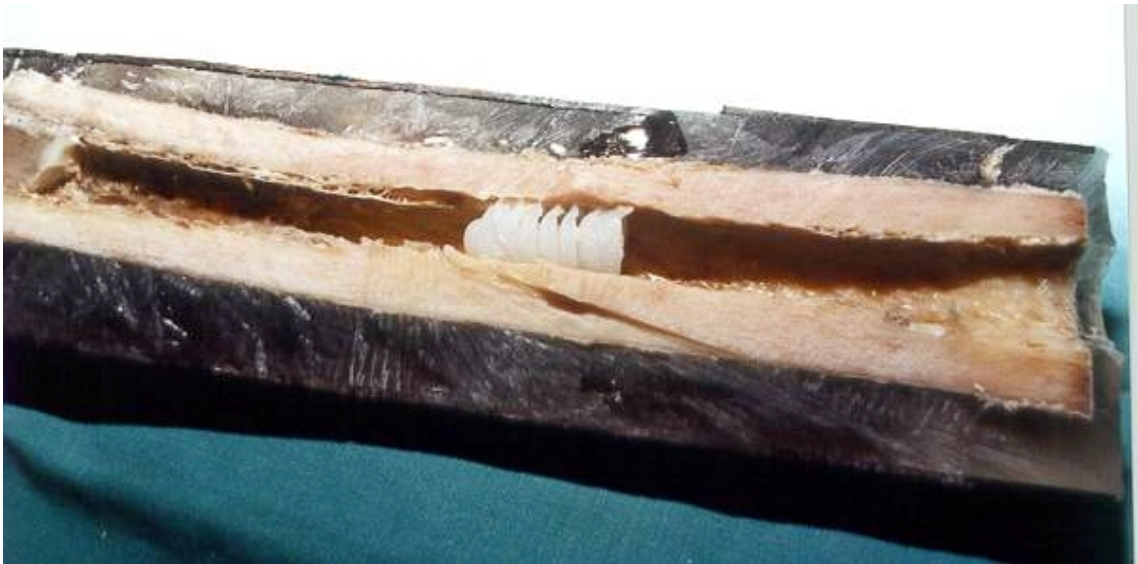
Abbildung 24: Press-fit und Verformung des Polyethylen Stoppers im Knochen.
