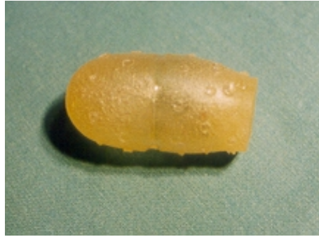
Abbildung 18: Erkennbare „Klebelinie“ an einem aufgeblasenen und geblockten Stopper (siehe 3.1.4)
