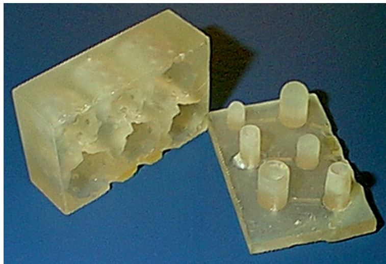
Abbildung 17: Gussform aus Kunststoff zur Herstellung der Gelatinestopper
