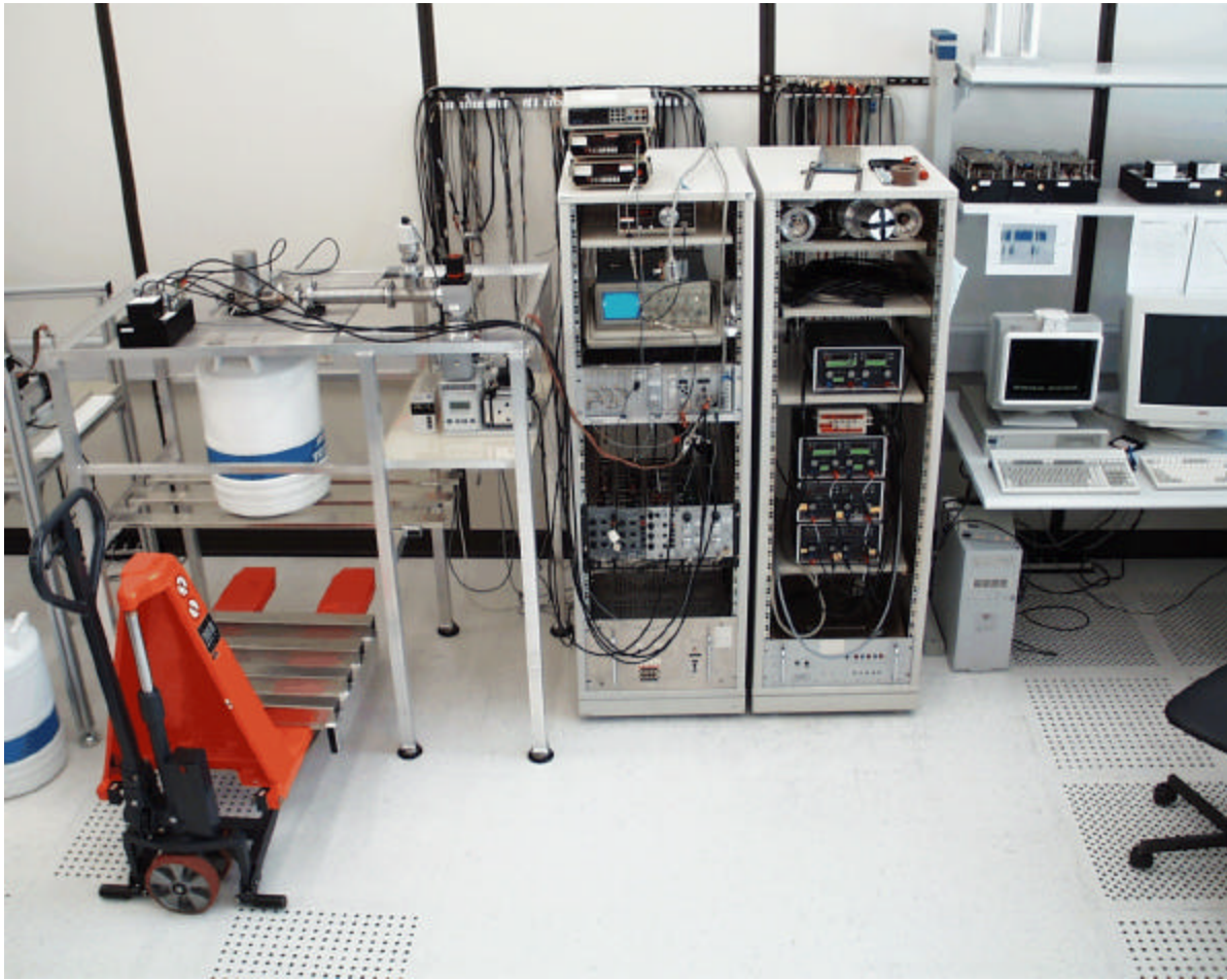
Abbildung 3.2 Messaufbau ACUMEN, mit dem das Rauschen von Transistoren in Abhängigkeit von der Temperatur, dem Betriebszustand des Transistors und der Frequenz gemessen werden kann.
