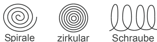
Abbildung 114: Mögliche Porenstrukturen der M41S Nadeln.
