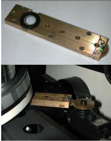
Abbildung 27: Drehbare \lambda/2 Platte (oberes Bild), die von Außen mit einem Servomotor gedreht werden kann (unteres Bild).
