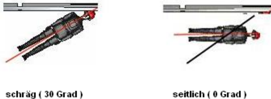
Abbildung 2.3: Anprallkonfigurationen für LIER-Tests (nach [68])
