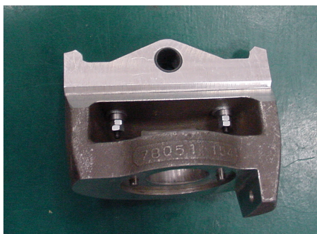
Abbildung 2.7: Modifizierte Dummy-Schulter entsprechend UNE 135900-1 (nach [70])
