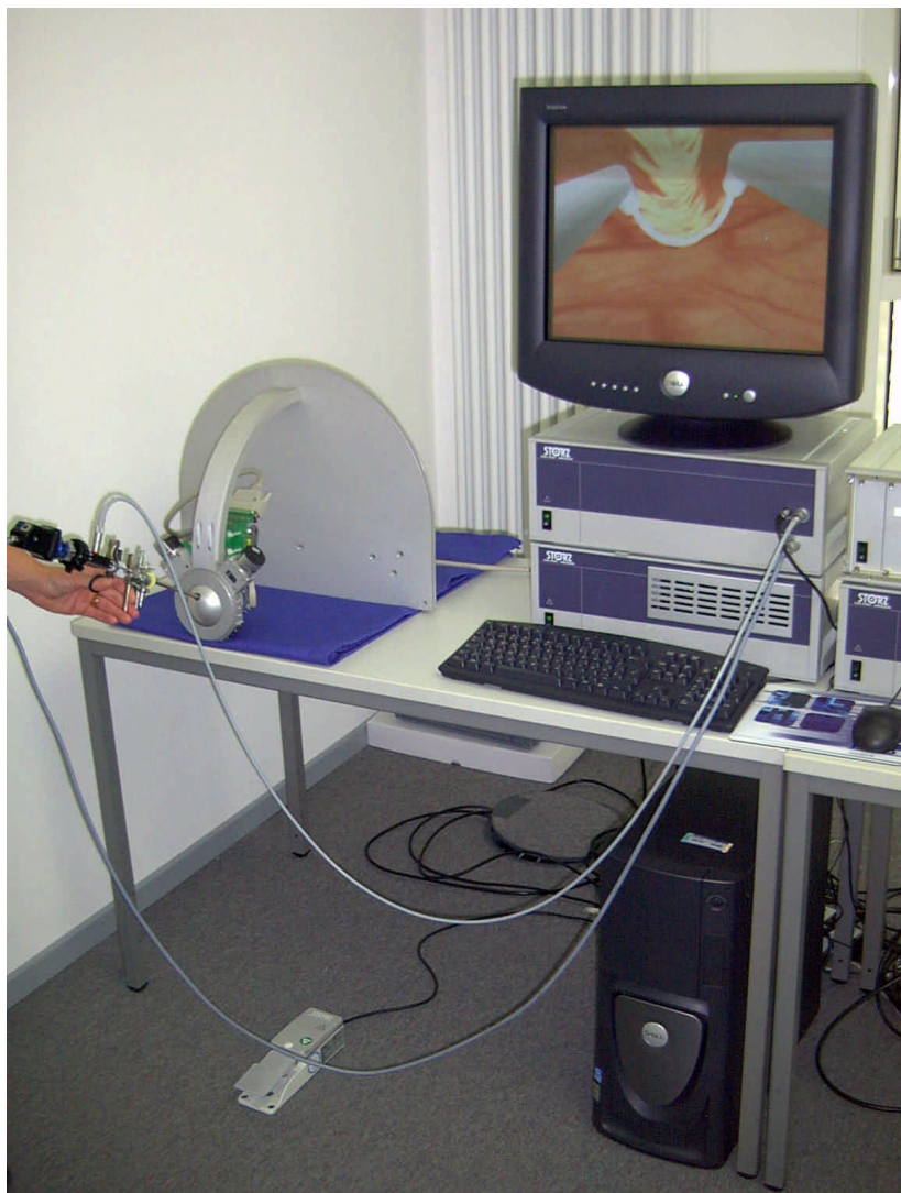
Abb. 19 Der Uro-Simulator. Die Resektionsschlinge ist zur Hälfte ausgefahren und ist auf dem virtuellen endoskopischen Bild der Harnblasenwand sichtbar. Unterhalb des Monitors sind die Ansteuerung, das DSP-Board und der PC. Die Mechatronikeinheit mit Resektoskop- und Kameradummy sind links daneben zu sehen.
