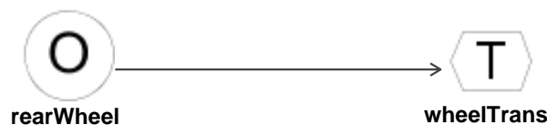
Abbildung 5.18: Ausschnitt aus dem Fahrradbeispiel; dem Objektknoten rearWheel wurde ein Transformationsattribut wheelTrans zugeordnet
