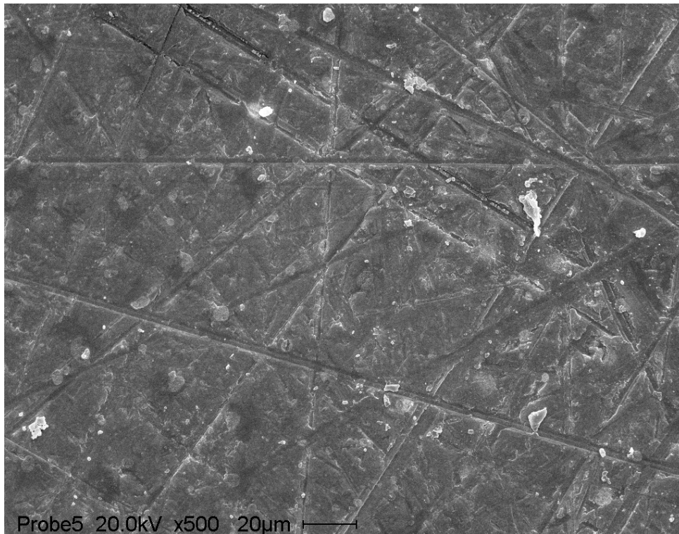
Abb. 4.10: 500fache Vergrößerung einer Keramikprobe deren Oberfläche mit feinem Schleifpapier bearbeitet wurde
