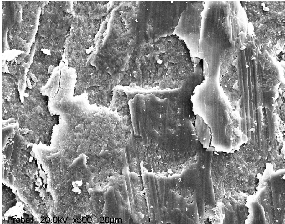
Abb. 4.2: 500fache Vergrößerung einer Keramikprobe mit Schleifspuren von einem Grünringdiamanten (Körnung 135 µm)
