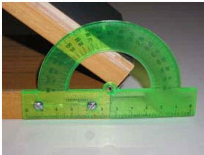
Abb. 3.5: Winkelmesser an der schiefen Ebene
