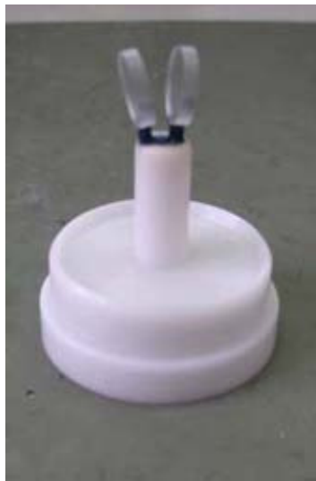
Abb. 3.2: Angestiftete Probekörper auf Muffelteller
