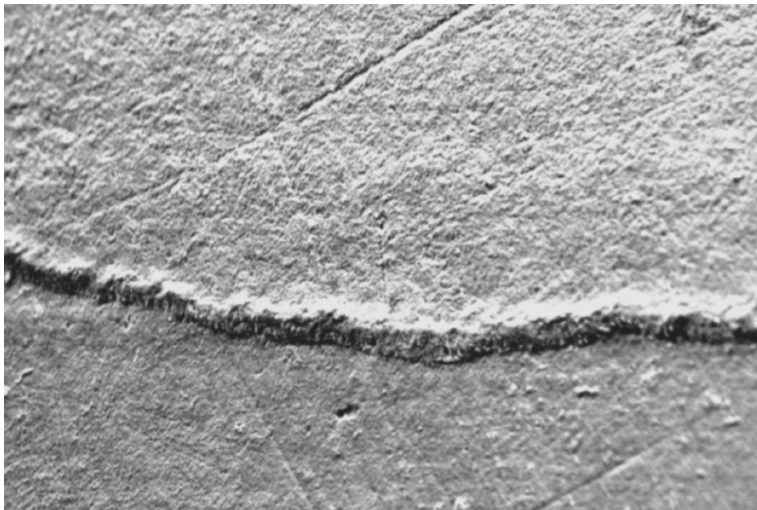
Abb. 14: Beispiel für eine Quellung, 15kV 200x
