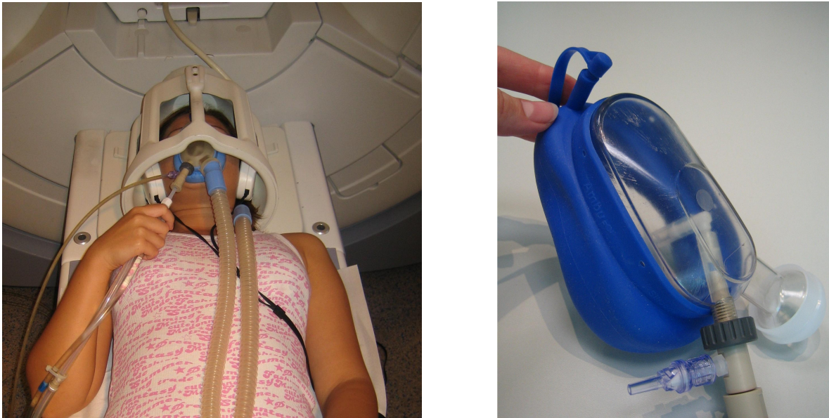
Abbildung 2.3: links: Probandin auf MRT-Liege mit Kopfhörern, Atemmaske des SDD und Abluftschläuchen; rechts: Atemmaske des SDD
