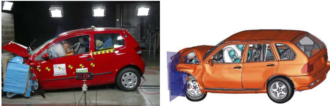
Abbildung 2.8: Realer Crashtest (aus [28]) und Crash-Simulation mit PAMCRASH (aus [9])
