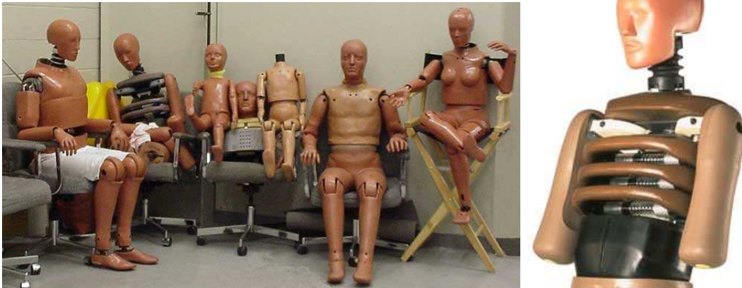
Abbildung 2.9: Dummy-Familie (aus [21]) und ES-2 (aus [28])
