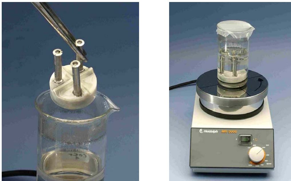
Abb. 4.1: Rührfisch mit Schrauben (links), Magnetprüher mit Becherglas (rechts)
