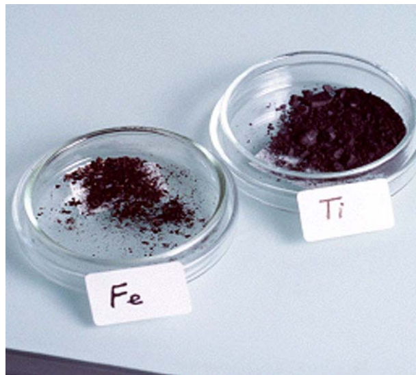
Abb. 4.2: Titan- und Stahlpartikel nach der Herstellung
