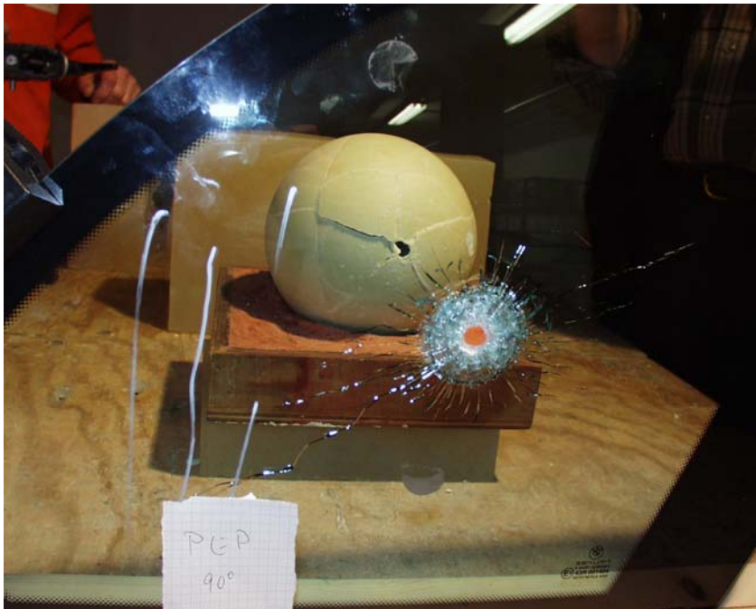
Abbildung 37: Beschossener Kunstschädel mit der P.E.P. unter einem Schusswinkel von 90 Grad
