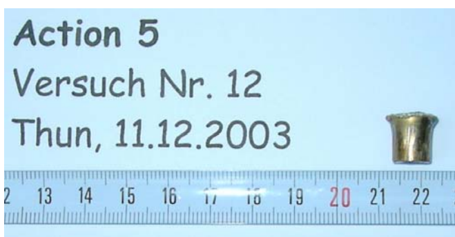
Abbildung 33 a+b: Deformiertes Action5 nach Beschuss unter einem Schusswinkel von 90 Grad
