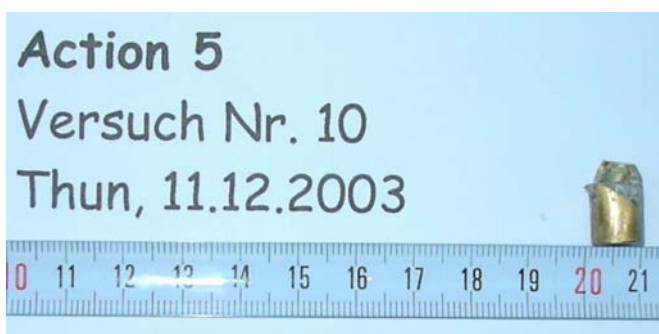
Abbildung 32 a+b: Deformiertes Action5 nach Beschuss unter einem Schusswinkel von 30 Grad
