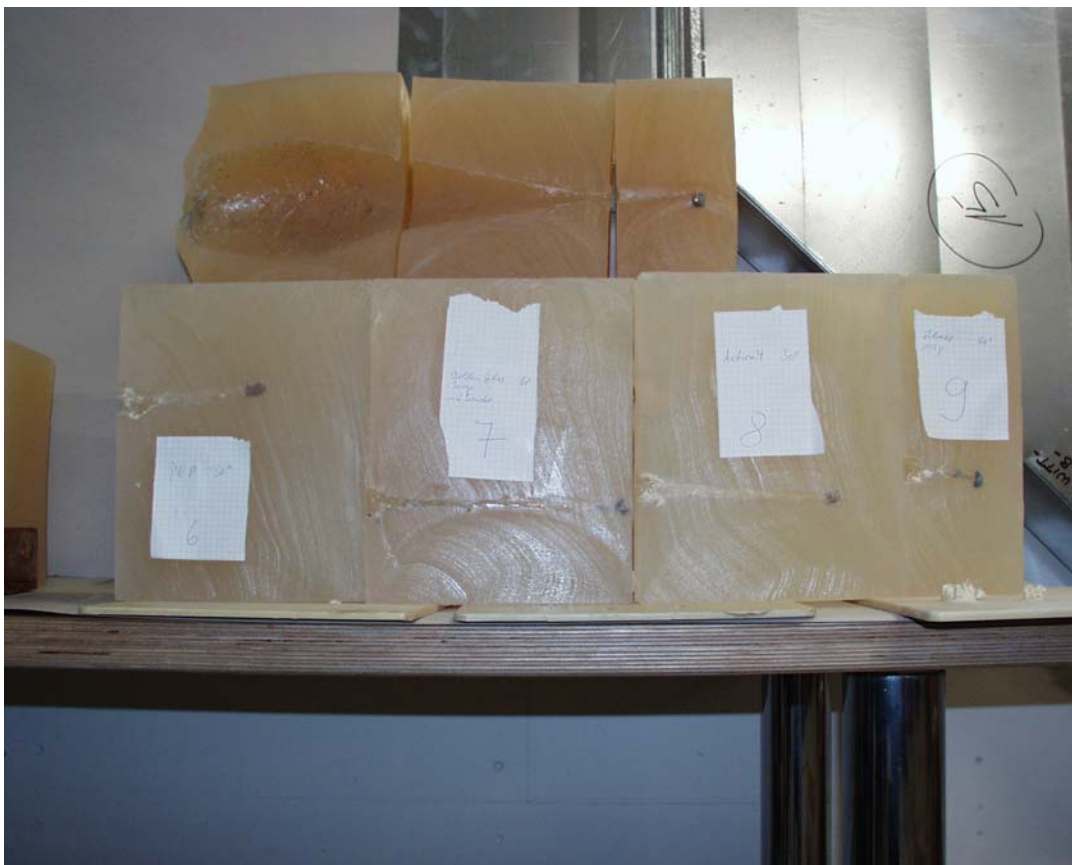
Abbildung 36 a+b: Querschnitte der beschossenen Seifenblöcke der Schüsse 1–9
