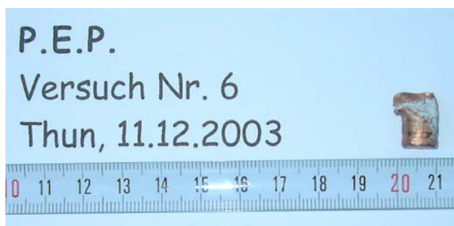
Abbildung 31 a+b: Deformierte P.E.P. nach Beschuss unter einem Schusswinkel von 30 Grad
