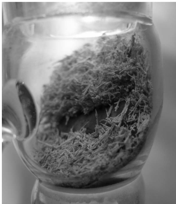
(a) Abscheidung von Silber-Nadeln bei der Reaktion von Silberazid mit Zinn.
