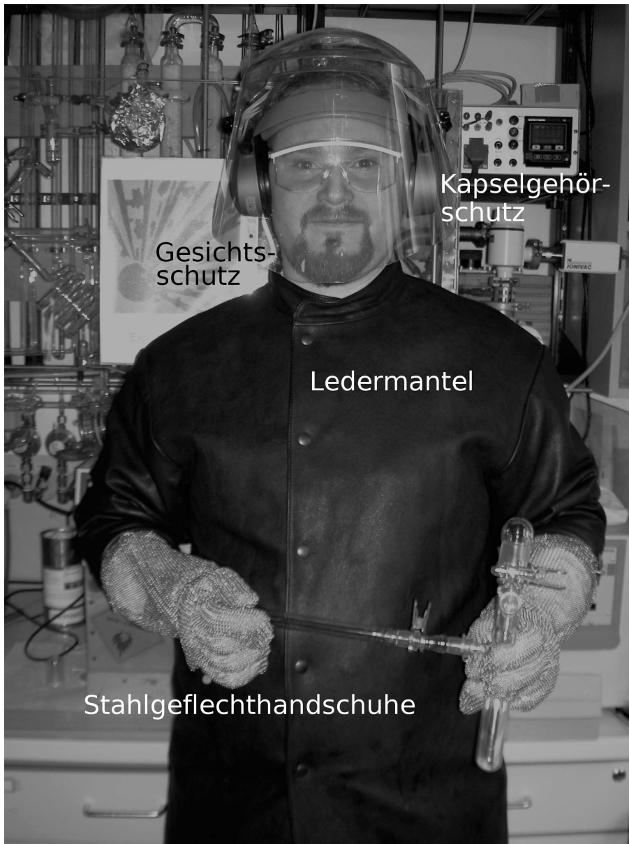
Abbildung 1.1: Persönliche Schutzausrüstung zum Umgang mit explosionsgefährlichen Stoffen. Der Splitterschutzmantel besteht aus zwei Schichten Leder mit einer gesamten Dicke von etwa 4 mm. Die Stahlgeflechthandschuhe sind nur wirksam und sinnvoll, wenn darunter Kevlar ® - oder Lederhandschuhe getragen werden, da das Stahlgeflecht gasdurchlässig ist und ansonsten die Gefahr von Verbrennungen bestünde. Der Vollgesichtsschutz muß aus splitterfreiem Kunststoff bestehen, und der Kapselgehörschutz verhindert Knalltraumen bei einer etwaigen Explosion. Es sei darauf hingewiesen, daß eine solche Schutzkleidung lediglich zum Umgang mit verhältnismäßig geringen Mengen explosionsgefährlicher Stoffe geeignet ist (etwa 100 bis 150 mg). Größere Mengen sollten daher nie auf einmal oder in nicht phlegmatisiertem Zustand verarbeitet werden.
