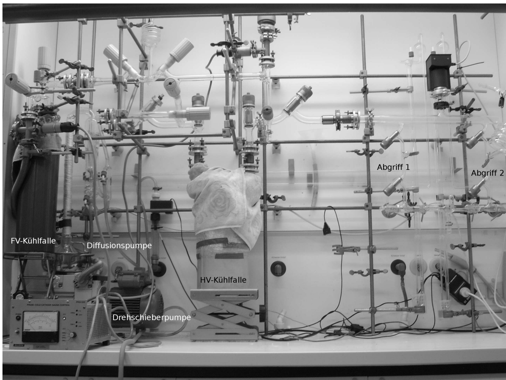
(b) Photographie der Hochvakuumapparat (Hg-Pumpe, Kapitel 1.3.1 auf Seite 14).
