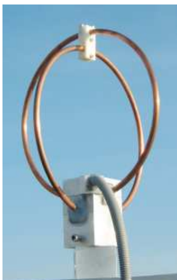
Abbildung 3.2: In dieser Arbeit verwendete magnetische Feldantenne zur Erfassung der atmosphärischen Impulsstrahlung
