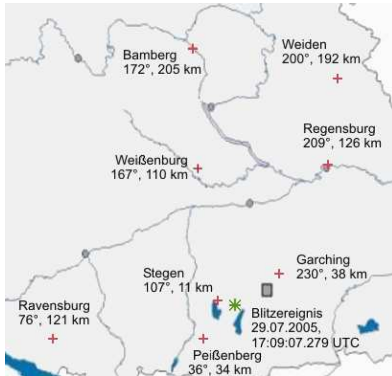
Abbildung 3.13: Registriertes Blitzereignis (Stern) an acht Stationen (Kreuze) mit der jeweiligen Einfallsrichtung und der Entfernung zum Blitzort
