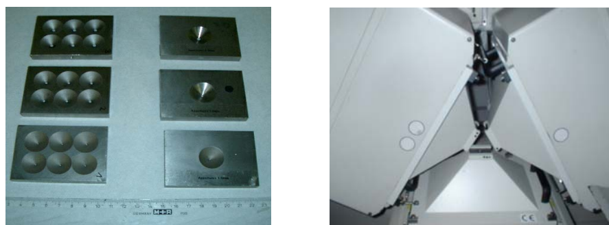
Abbildung 10: Links: Die Abbildung stellt die verwendeten Wolfram-Pinholeaufsätze dar. (Linkes Bild, links: Sechs-Loch-Pinholeaufsätze mit von oben nach unten 3, 2, 1 mm Öffnungsdurchmesser; linkes Bild, rechts: Ein-Loch-Pinholeaufsatz mit von oben nach unten 3, 2, 1mm Öffnungsdurchmesser. Rechtes Bild: Aufnahme des Pinhole-SPECT-Systems mit montierten Pinhole-Kollimatoren.)
