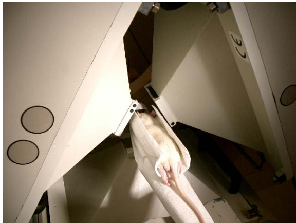
Abbildung 11: Links: Schematische Darstellung der Anordnung der drei Pinhole-Kollimatoren um das untersuchte Objekt. Rechts: Photographie des experimentellen Aufbaus bei der Datenakquisition im Tierexperiment.
