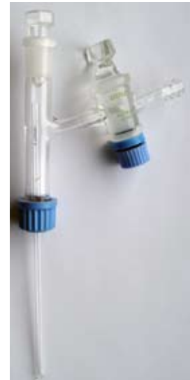
Vorrichtung zur Befüllung von NMR-Proben unter Schlenkbedingungen
