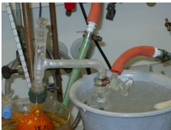
Synthese von AdPCl_2 : »Feststoff« Destillation
