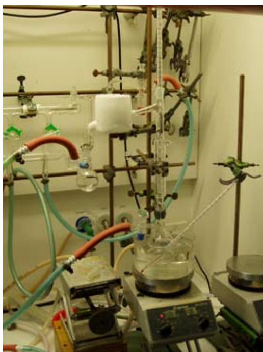
Synthese von F_3CPCl_2 : Destillation mit Vigreux-Kolonne unter Kühlung auf -78^\circ C
