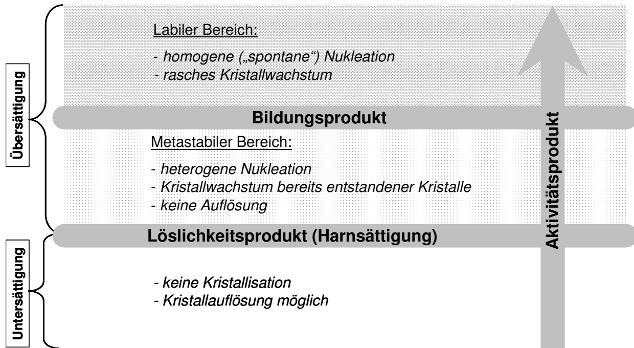
Abb. 3: Schematische Abstufung des Übersättigungsgrades einer wässrigen Lösung. Aktivitätsprodukt – effektive Konzentration der relativen Ionen; Löslichkeitsprodukt – beschreibt die Ionenkonzentration für eine gesättigte Lösung; Bildungsprodukt – der Bereich der kritischen Lösungsübersättigung [ALLEN & KRUGER (2000), BARTGES et al. (2004), MARKWELL et al. (1998a), NANCOLLAS (1976)]
