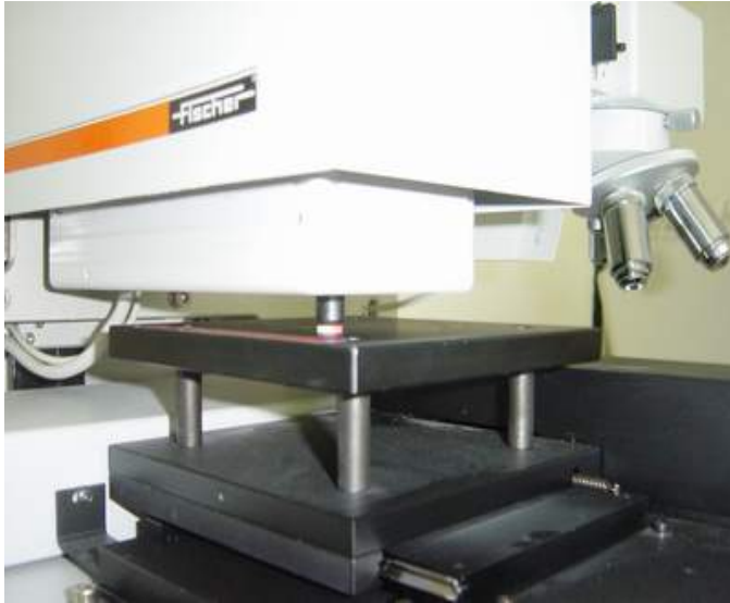
Abb. 17: Messtisch mit Kompositprobe unter Messzylinder.
