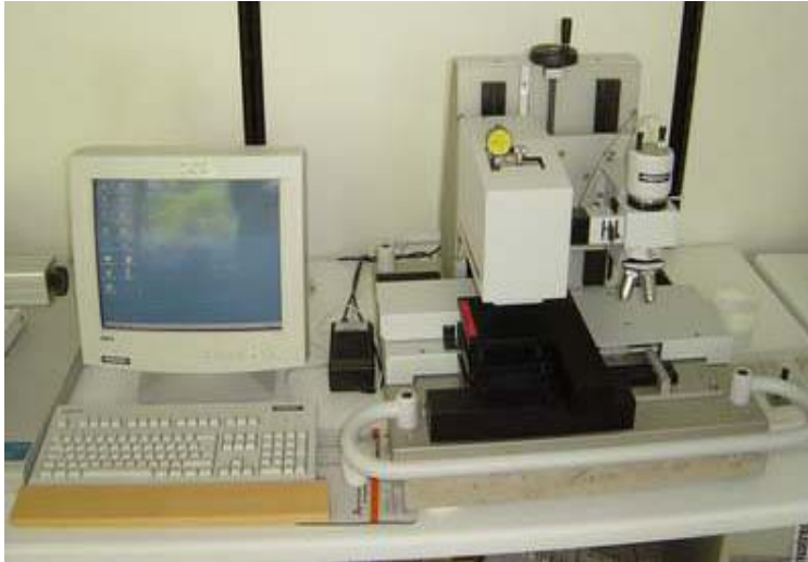
Abb.14: Vickershärteprüfgerät, Fischerscope H100C, Fa. Fischer GmbH, Sindelfingen.
