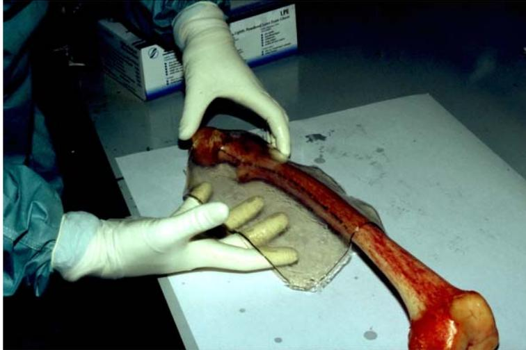
*Abbildung 3-11: Aufmodellieren einer spannungsoptischen Schicht.*
