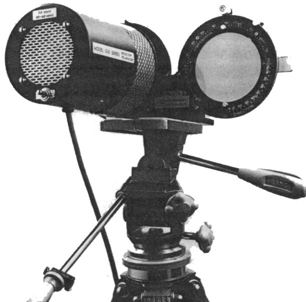
Abbildung 3-9: Reflexionspolariskop.
