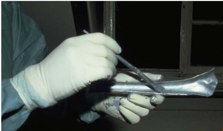
*Abbildung 3-15: Auftragen eines aluminiumhaltigen Zwei-Komponentenklebers.*
