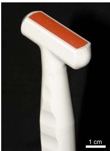
**Abb. 1:** 15 MHz-Linearsonde (Philips Sonos 7500)
