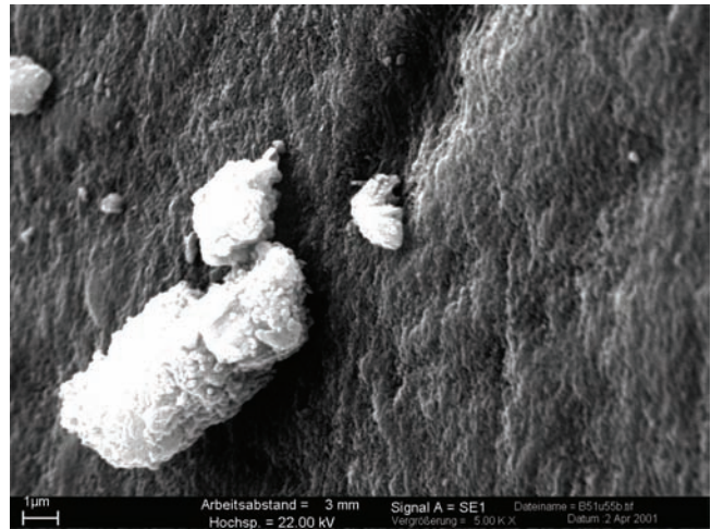
C und D Bittenbrunn Ind 51 (Detail D 5000x) Kratzspuren mit weicher Kante, verbreitertem Ende, teilweise mit endständiger Auflagerung
