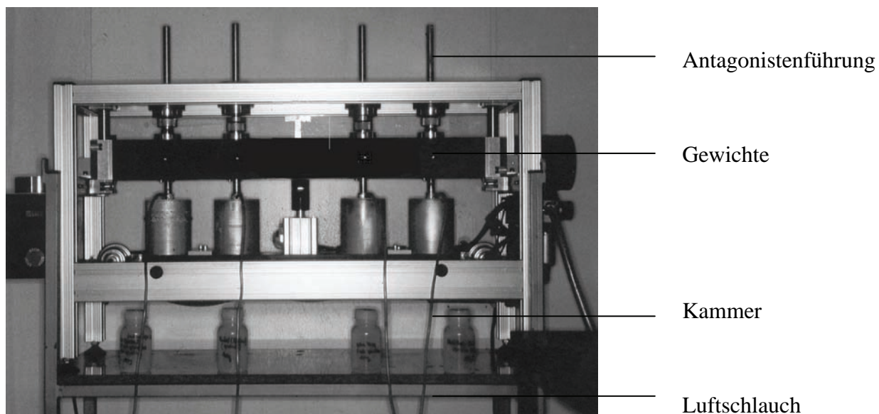
Abb. 28 Vier-Stationen-Kaukraftsimulator MUC3 nach Kunzelmann
