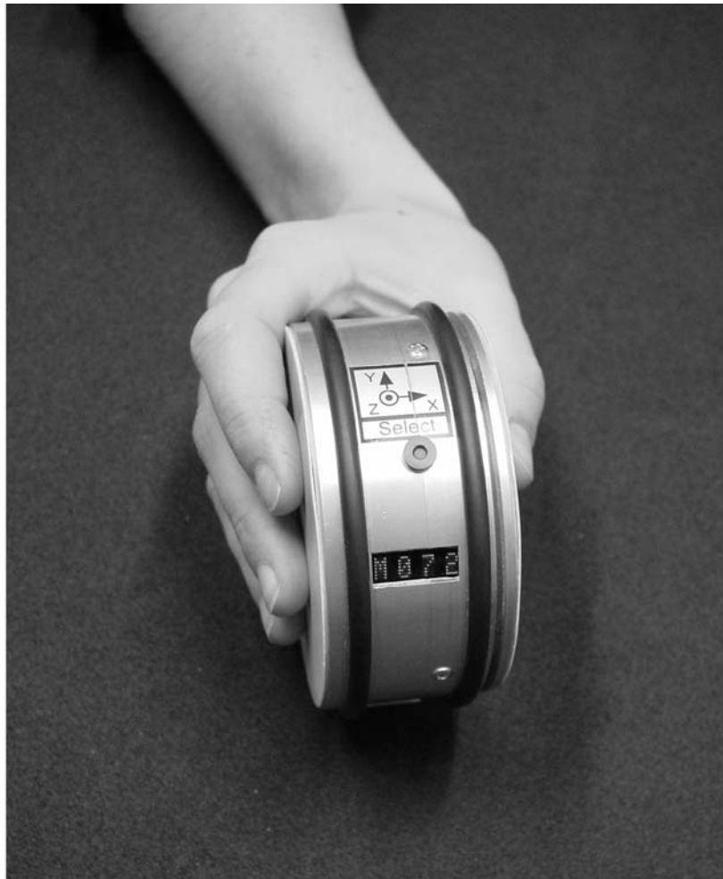
Abbildung 9: Die „Thunfischdose“ – das Messsystem zur kabellosen Untersuchung der Griffkraft
