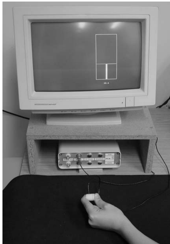
Abbildung 6: Meßsystem FCA: Der zylinderförmige Kraftsensor wird im Präzisionsgriff gehalten. Die resultierende aktuelle Griffkraft ist in Form eines vertikalen Balkens, die Zielkraft als dünne horizontale Linie auf dem Monitor dargestellt.
