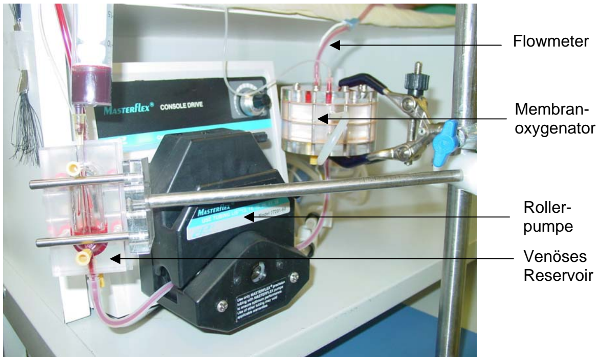
Abbildung 6: Herz-Lungen-Maschine mit venösem Reservoir, Rollerpumpe, Membranoxygenator, Flowmeter und verbindenden Silikonschläuchen (Aufnahme: Arbeitsgruppe „Experimentelle Anästhesiologie“, Klinikum rechts der Isar, München)
