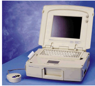
Abb. 5: Das Programmiergerät stellt eine Zweiwege-Hochfrequenzverbindung mit der implantierten Pumpe her, sendet Abfrage- und Programmiersignale an die Pumpe und erhält von dieser Statusinformationen zurück.(Telemetrie).
