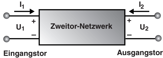
Abbildung 2.9.: Schema eines Zweitores, mit den vier relevanten Größen.
