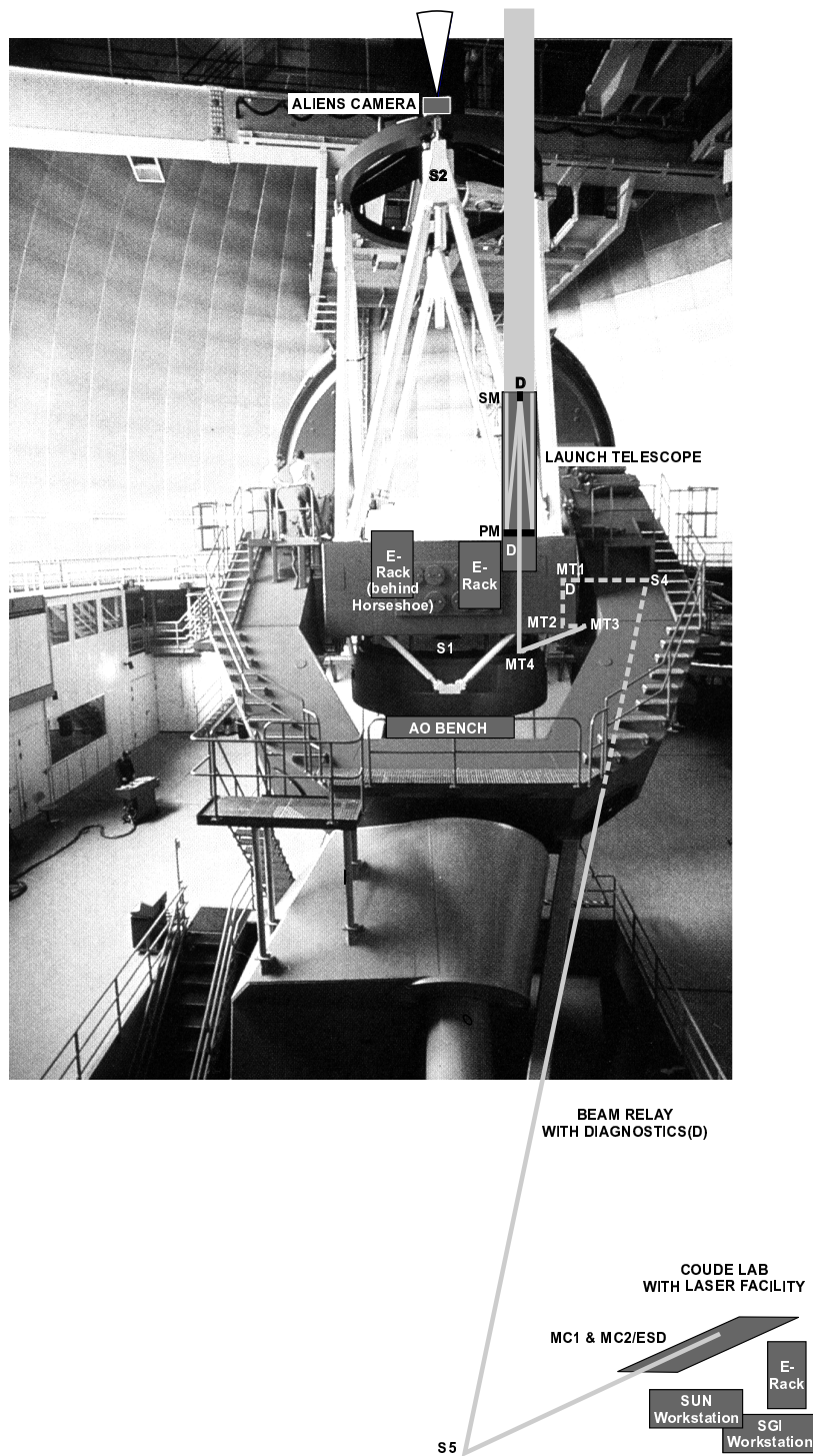
Abbildung 2.1: Schematische Darstellung des LLS-Systems von ALFA am 3.5-m-Teleskop auf Calar Alto. Es können im wesentlichen vier Untersysteme unterschieden werden: Die Laseranlage im Coudé-Geschoß, das Laserstrahl-Transportsystem, das Projektionsteleskop mit seinen Diagnoseeinrichtungen, sowie die Luftraum-Überwachungskamera hinter dem Sekundärspiegel des großen Teleskops.
