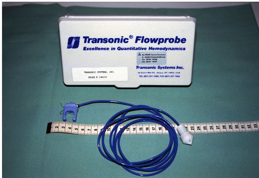
Abbildung 7: Ultraschallflusssonde; Durchmesser 14mm (Transonic® Flowprobe)
