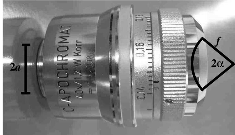
**Abbildung 4.1.:** Das verwendete Objektiv (Zeiss C-Apochromat 40x/1,2 W korr). Der Aperturradius beträgt laut Herstellerangaben  $a = 4,5$  mm. Bei der Vergrößerung  $M = 40$  wird die nominale Brennweite  $f = 4,11$  mm. Mit der Numerischen Apertur  $N.A. = 1,2$  in wässriger Umgebung ( $n = 1,33$ ) ist der Winkel  $\alpha = 64,5^\circ$ . Mit der im Bild horizontalen Skala lässt sich die Dicke eines Deckglases zwischen 0,13 mm und 0,18 mm korrigieren.
