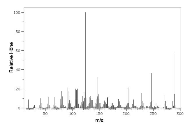
Abb. 9: Massenspektrum von Testosteron
