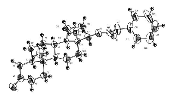
**Abb. 20a:** Röntgenstruktur von 3-Oxo-5 **a**-androstan-17-O-phenyl**b**-thioameisensäureester (**16**)
