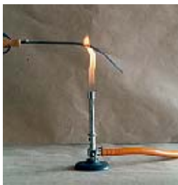
Abb. 30.2: Bimetallthermometer beim Erwärmen
