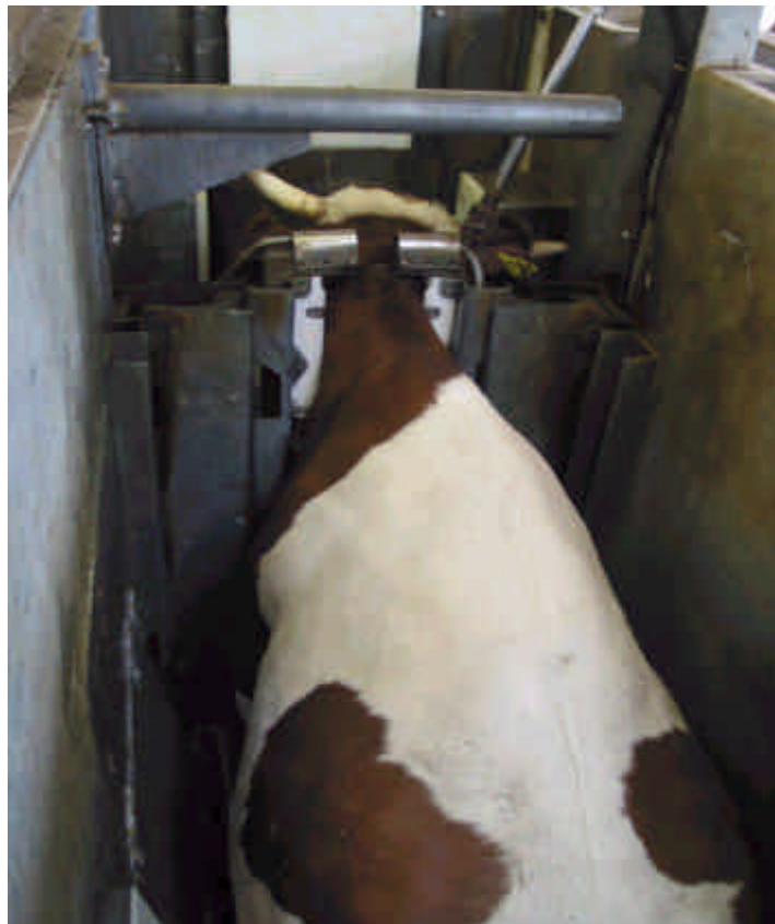
Abb. 7: Rückansicht der Betäubungsbox. Das Rind ist gut fixiert und während der Durchströmungsphase in den Hintergliedmaßen eingeknickt
