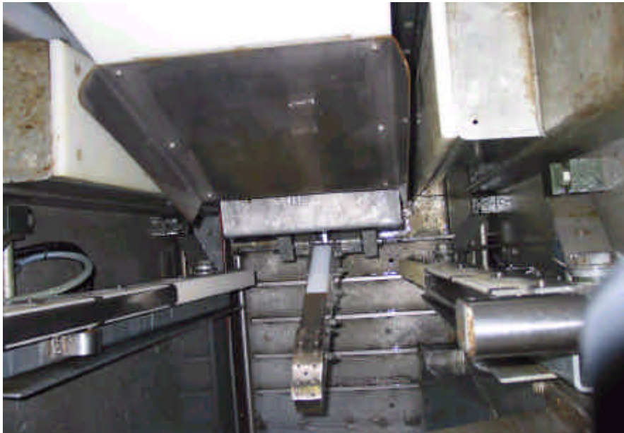
Abb. 6: Betäubungselektroden von oben: Flotzmaulelektrode (große Metallplatte), Herzelektrode (Mitte), Nackenelektroden (links und rechts)
