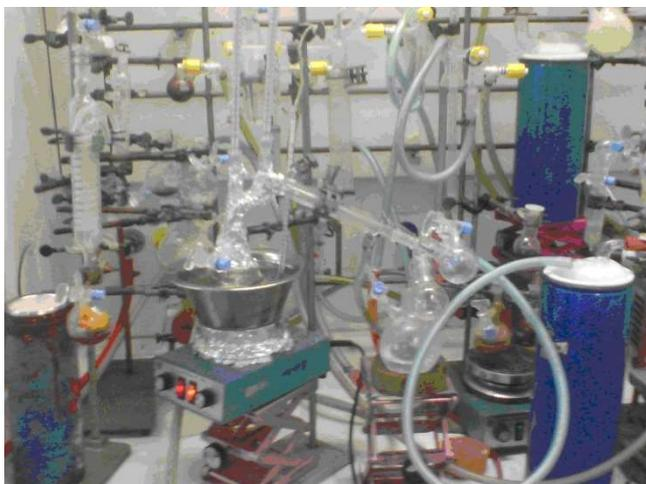
Aufbau der Destillationsapparatur
