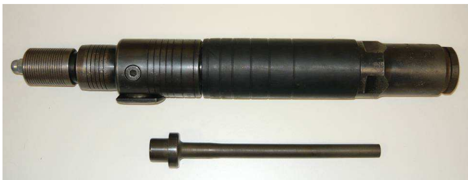
Abb. 8: Bolzenschussapparat Schermer Schussapparat Typ KS mit herausgezogenem Schussbolzen
