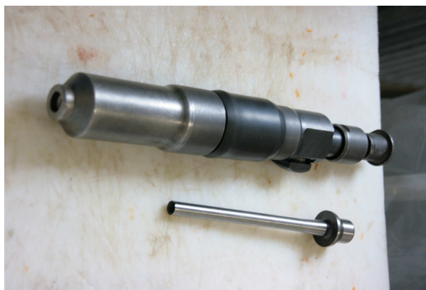
Abb. 7: Bolzenschussapparat EFA Cash Magnum 9000S mit herausgezogenem Schussbolzen
