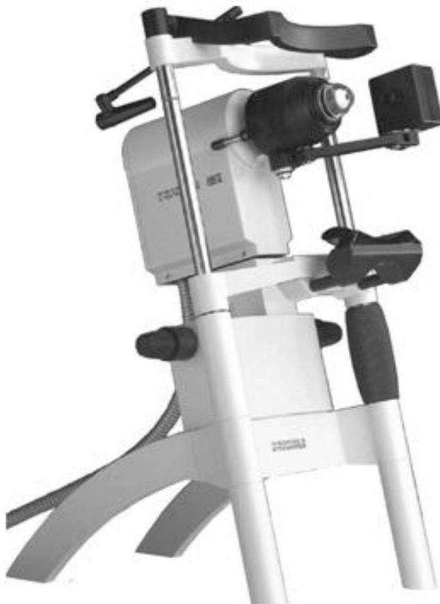
Abb. 4: Der Heidelberg Retina Tomograph HRT II mit aufgestecktem Rostock Cornea Module (RCM).
