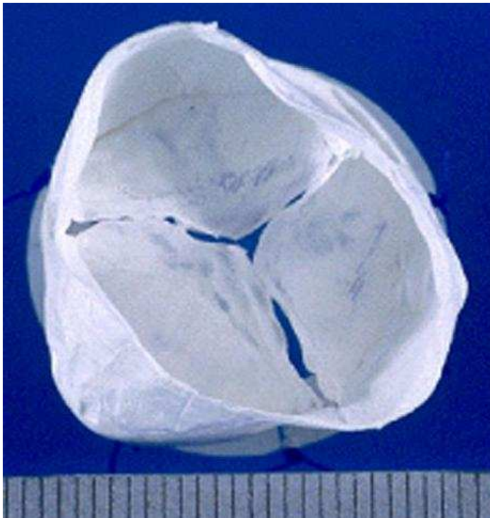
Abb. 48 Herzklappenkonstrukt aus porösem Poly-4-Hydroxybutyrat basierend auf dem Stereolithographieverfahren
