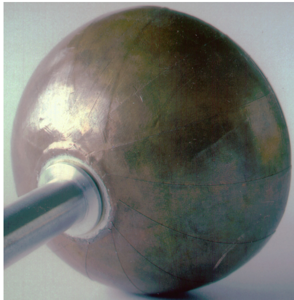
Abbildung 3.15: Kammerabschirmung im Detail. Sichtbar sind die überlappenden Kupferklebefolien.
