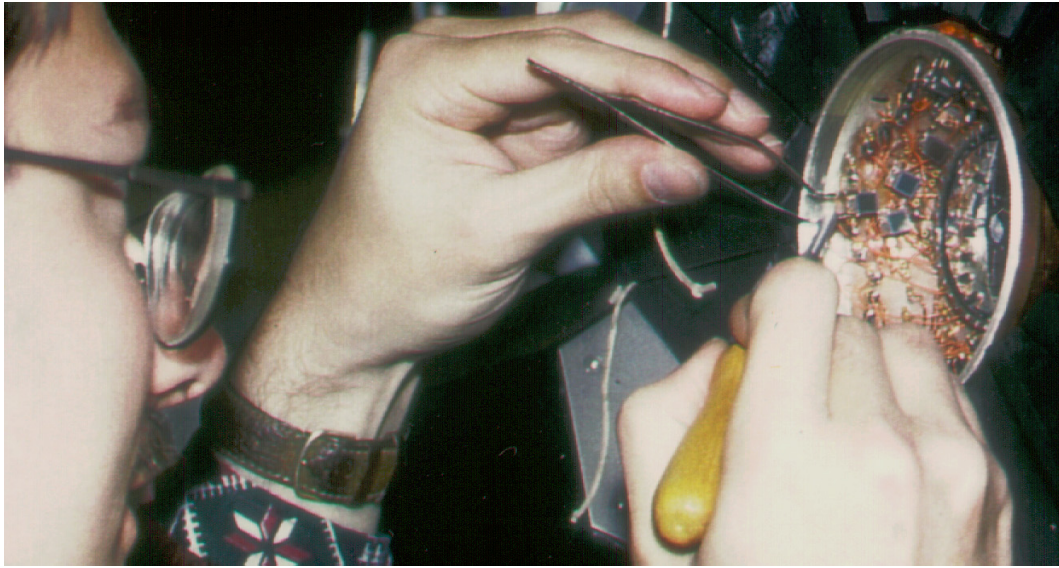
Abbildung 3.7: Austausch von PIN-Dioden am Detektorsystem
