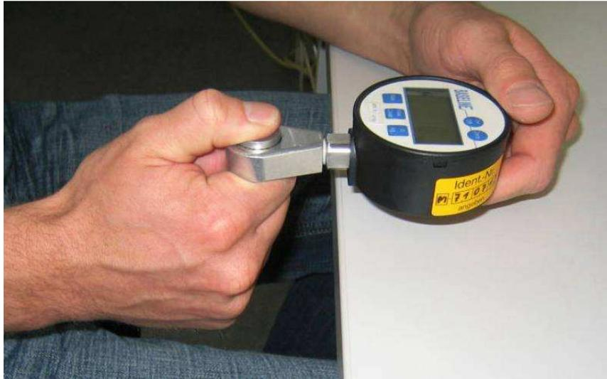
Abbildung 13: Bestimmung der Kraft im Schlüsselgriff („key pinch“) mittels „Baseline® key pinch gauge“.
