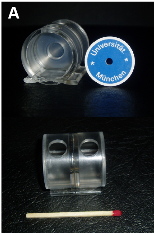
Abb. 2.6. Elektrophysiologische Analyse in einem planaren Lipidbilayersystem. A) Messkammer mit Teflonmembran, welche mit einem 100 \mu\text{m} großem Loch versehen ist, in das mittels der Painting-Technik eine plane Lipid-Doppelschicht („lipid bilayer“) eingebracht wird. B) Schematische Darstellung des gesamten Messsystems und beispielhafte Rohdatenspur.
